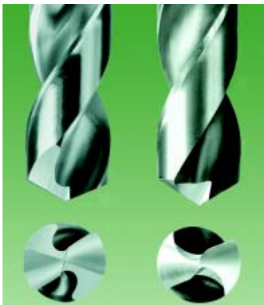
Fig. 6 - La pointe des forets classiques demande souvent à être divisée (vue de gauche) ou encochée (vue de droite) afin de diminuer l'épaisseur de l'âme au niveau de l'arête transversale et de réduire la poussée d'avance nécessaire à la pénétration dans le métal. L'opération de rectification en reprise peut entraîner des accroissements de coûts, des imprécisions des trous et une usure rapide du foret.
